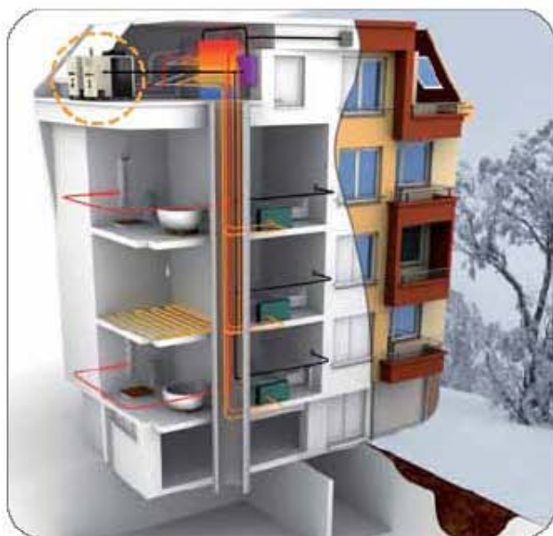
Пример использования GANP-AR в зимнем и летнем режиме с системой с "теплыми полами", фанкойлами, с непрямым нагревом бытовой горячей воды.
