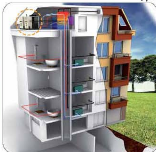
Пример использования GANP-AR в зимнем и летнем режиме с системой с "теплыми полами", фанкойлами, с непрямым нагревом бытовой горячей воды.
